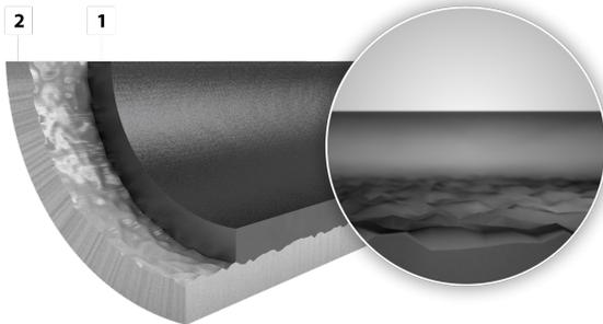
ILAFLON Select R ist ein einschichtiges System auf PTFE-Harz-Basis welches vor allem für Microwellen Innengehäuse, Mini-Backofen oder u.U. auch für Brotbackautomat-Knethaken verwendet werden kann.
