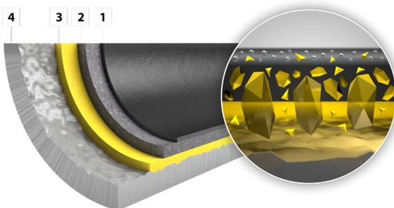
DURIT Protect Pro ist ein dreischichtiges Antihafteffekt-System, keramisch verstärkt, für höchste Anforderungen - bestens geeignet für den Einsatz vor allem bei Top Level Cookware. Durch die exzellente Kombination von Kratzfestigkeit und Abrasionsbeständigkeit, in Verbindung mit bestem Antihafteffekt, ist dieses System die richtige Wahl.
